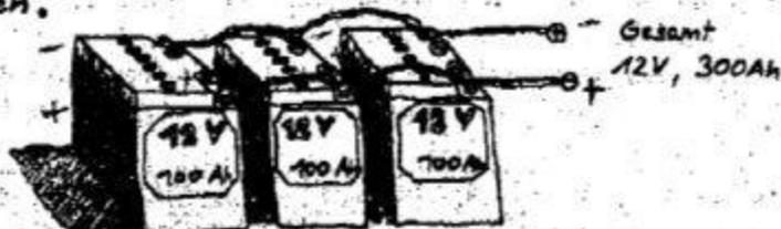
In Parallelschaltungen addieren sich die Kapazitäten zusammen. Die Spannung bleibt gleich.
